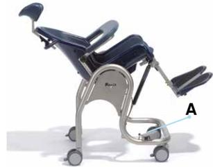
Das Fußpedal (A) kann mit dem Zugspannstift, der sich auf der Innenseite des Fußpedals befindet, gegen ungewollte Bedienung gesichert werden. Hierzu den Zugspannstift drehen, bis er einrastet. Eventuell durch leichtes Bewegen des Fußpedals das Einrasten unterstützen. Die Arretierung wird aufgehoben, indem der Zugspannstift herausgezogen und um eine Viertelumdrehung verdreht wird.
