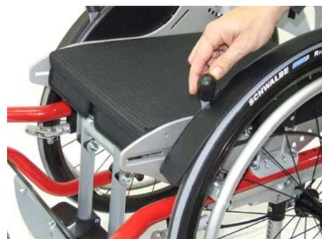
Der Bremsbügel soll bei geöffneter Bremse einen Abstand von ca. 12 -15 mm zum Rad haben (A).
