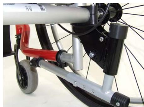
Der Rollstuhl kann mit einer oder zwei Kippschutzeinheiten ausgerüstet sein.
