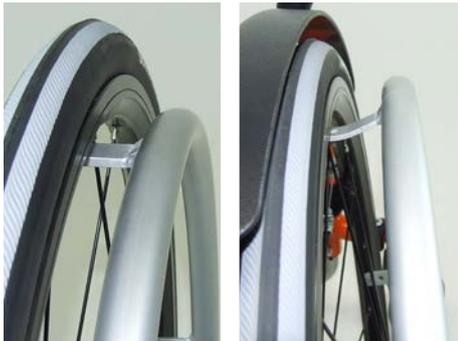
Es können Greifreifen mit einem Standarddurchmesser oder mit einem größeren Durchmesser angebaut werden. Man bezeichnet das als Greifring „standard“ bzw. Greifring „hoch“.
