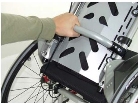
Ist Ihr Rollstuhl mit einem abklappbaren Rücken ausgestattet, könnte dieser zum Transport eingeklappt sein.
