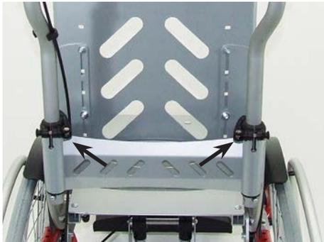
Ist Ihr Rollstuhl mit einem abnehmbarem Schiebebügel ausgestattet, haben Sie zusätzlich die Möglichkeit die Höhe des Schiebebügels nach dem Lösen der Exzenterhebel (siehe Markierung) in den Griffhaltern zu verstellen.
