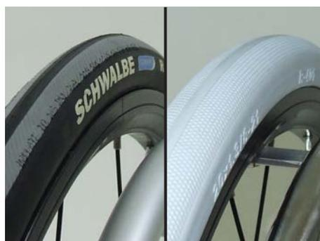
Die Antriebsräder können auch mit pannensicherer PU-Bereifung ausgestattet werden.
