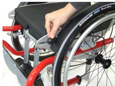
Der Bremsbügel drückt auf den Reifen und hält diesen fest. Dabei steht der Bremsbügel im 90° Winkel zum Halter. Der Bremsbügel soll ca. 3-5 mm über die Radmitte hinausstehen.
