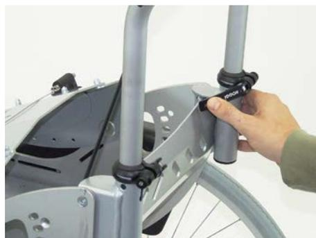
Die Schließkraft des Exzenterhebel kann durch Verstellen der Rändelmutter bei geöffnetem Hebel eingestellt werden.
