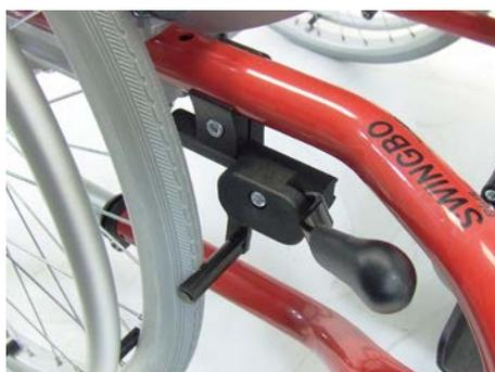
Der Bremsbügel drückt auf den Reifen und hält diesen fest. Dabei steht der Bremsbügel ca. im 90° Winkel zum Halter. Der Bremsbügel sollte soweit als möglich über die Radmitte hinausstehen, jedoch nicht über die Radaußenseite hinaus stehen.
