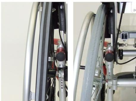
Der **SWINGBO 2** kann mit einem Radsturz von 3° (nicht abgebildet), 6° oder 9° ausgestattet werden.
