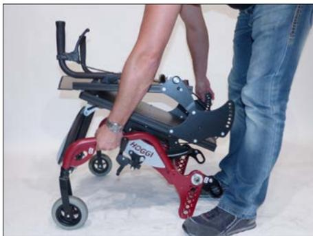
Fassen Sie den Rollstuhl zum Anheben wie abgebildet nur an fest verschweißten bzw. fest verschraubten Rahmenteilen an (am Seitenrahmen oberhalb der Lenkräder).
