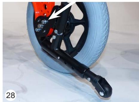
Der Kippschutz wird so eingestellt, dass die Rolle am Ende des Kippschutzrohres über den Radius des Antriebsrades hinausragt und ca. 2-3 cm über dem Boden steht (29).
