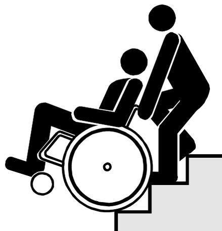
Beim **Hinauffahren** einer Treppe fahren Sie oder die Begleitperson den Rollstuhl rückwärts und senkrecht an die erste Treppenstufe heran. Die Begleitperson kippt den Rollstuhl auf die Antriebsräder und zieht den Rollstuhl an den Schiebegriffen Stufe für Stufe aufwärts.
