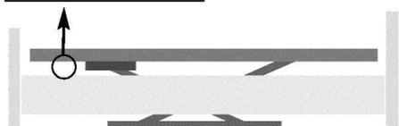
Die Oberkante des Liegeflächenrahmens [1] muss 75 mm über der Oberkante des Bettumbaus abschließen!
