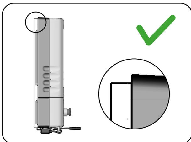
Abb. 8.7.03 – Akkupack richtig an der Montageschiene montiert
