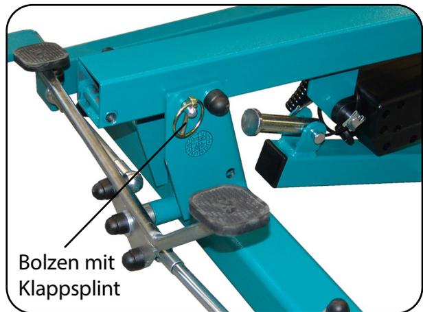
Abb. 6.2.02 – Standmastaufnahme
