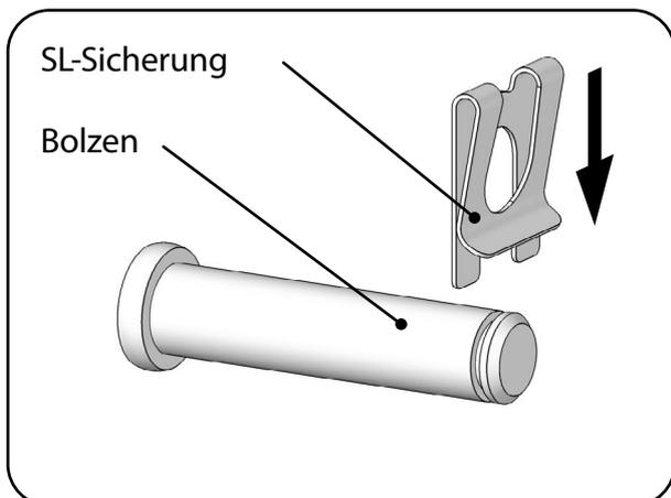
Abb. 6.1.03 – Montage der SL-Sicherung am Bolzen
