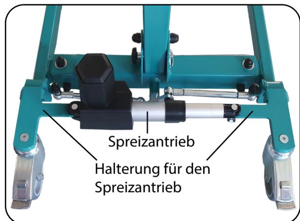
Abb. 8.4.03 - elektrische Spreizung
