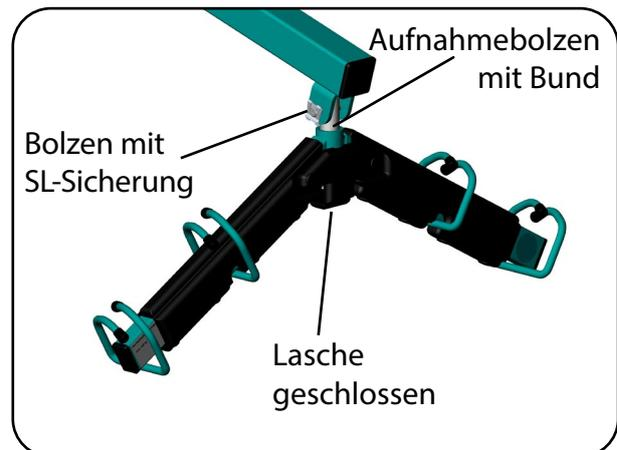
Abb. 6.2.07 - Transportbügel montiert
