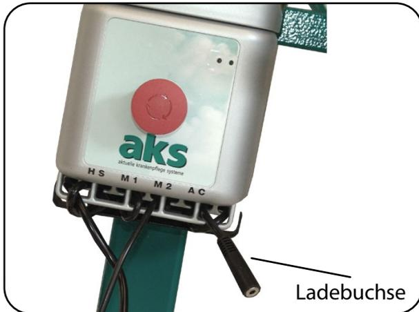
Abb. 8.7.05 – Steuereinheit mit Ladebuchse
