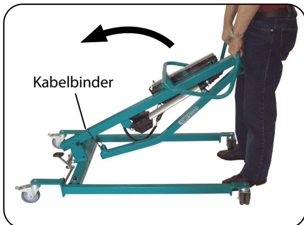
Abb. 6.2.03 – Standmast aufrichten
