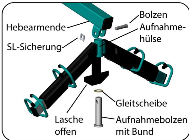
Abb. 6.2.06 - Montage Transportbügel
