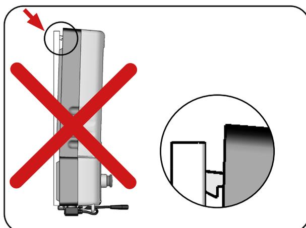
Abb. 8.7.04 – Akkupack falsch an der Montageschiene montiert
