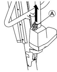
Die effektive Senkgeschwindigkeit hängt vom Patientengewicht ab. Ist die Geschwindigkeit zu niedrig oder zu hoch, kann sie an das Patientengewicht angepasst werden. Einstellen der Absenkgeschwindigkeit:
