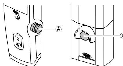
1. Drücken Sie die rote Notaus-Taste A an der Steuerungseinheit, um den Ausleger anzuhalten und das Heben bzw. Absenken des Patienten zu unterbrechen.
