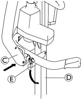
Drücken und halten Sie den Ausleger © in Richtung des Masts © und klappen Sie den Halter © des Spreizbügels nach unten.
