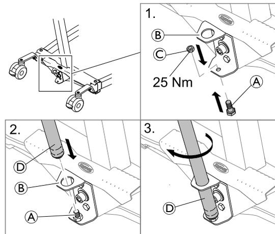
1. Stecken Sie den Bolzen ① von unten in das untere Loch der Halterung ② und befestigen Sie ihn mit der Mutter ③.
