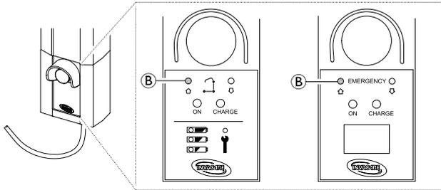
Wenn das Handbedienteil nicht anspricht, kann der Ausleger mit dem Schalter für die Notabsenkung angehoben werden. Drücken Sie die Taste mit einem spitzen Gegenstand, z. B. einem Bleistift.
