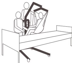
Heben Sie den Lifter an oder senken Sie ihn ab, um den Patienten über dem stehenden Objekt zu positionieren. Heben Sie den Patienten so weit an bzw. senken Sie ihn so weit ab, dass er nicht an den Seiten des stehenden Objekts hängen bleibt.
