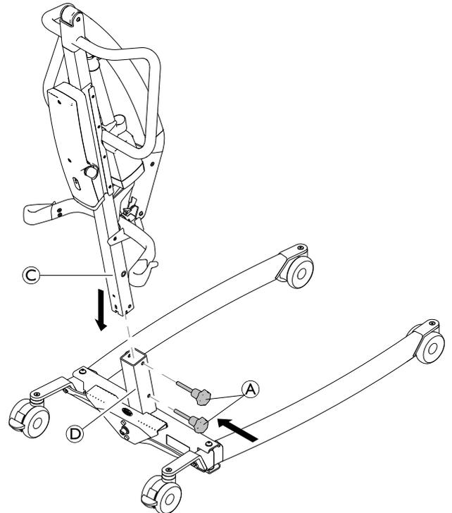
Schieben Sie den Mast ③ nach unten in die Halterung der Basis ④, wobei der Ausleger nach vorne weist. Bringen Sie dann die Handschrauben ① wieder an, um den Mast ③ an der Basis zu befestigen.
