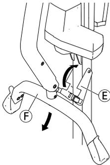
Klappen Sie den Spreizbügel © nach unten und klappen Sie den Halter © des Spreizbügels nach oben.
