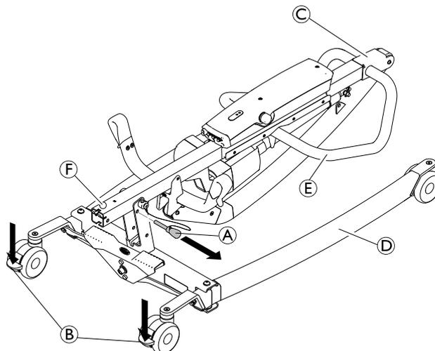
1. Verriegeln Sie die beiden hinteren Rollen ②. Entfernen Sie den Verriegelungsstift ①.
