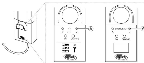
Wenn das Handbedienteil ausfällt, kann der Ausleger mit der Rundtaste für die Notabsenkung abgesenkt werden. Drücken Sie die Taste mit einem spitzen Gegenstand, z. B. einem Bleistift.
