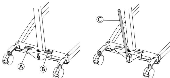
Die manuelle Fahrgestellspreizung wird mit zwei Fußpedalen (A) und (B) oder mit dem Hebel C betätigt.
