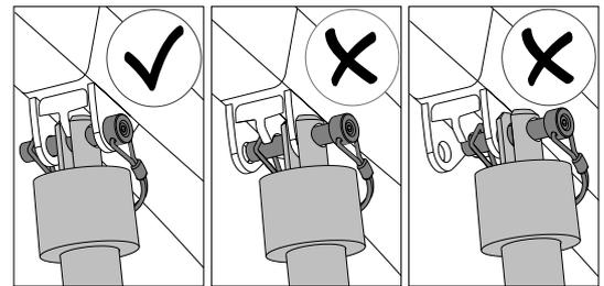
Richten Sie die Löcher aus und setzen Sie den Stift © wieder ein. Vergewissern Sie sich, dass der Stift vollständig eingeführt ist, und sichern Sie ihn mit der D-Klemme.
