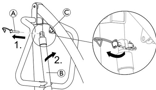
1. Lösen Sie die D-Klemme und entfernen Sie den Stift © vom Verstellmotor ©.
