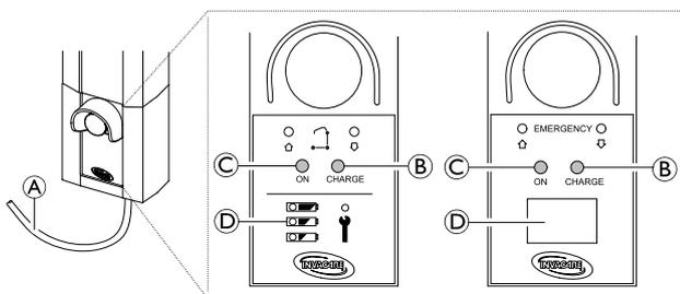
Die Steuerungseinheit ist mit einem akustischen Signal ausgestattet. Ein Signal gibt an, dass der Akku schwach ist, der Patient jedoch noch abgesenkt werden kann. Es wird empfohlen, den Akku aufzuladen, sobald das akustische Signal ertönt.
