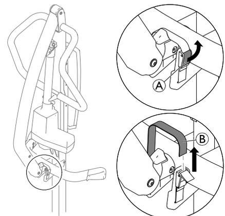
Öffnen Sie den Klemmverschluss ① und entfernen Sie das Band ② aus der Klemmschnalle.
