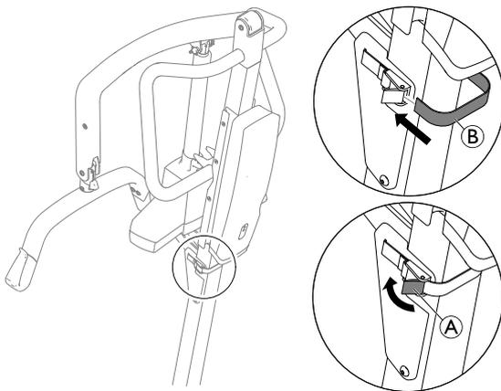
Wickeln Sie das Band © um die Rückseite des Mastes, führen Sie es in die Klemmschnalle ein und schließen Sie den Klemmverschluss ©.
