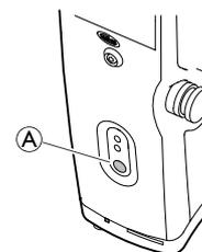
1. Senken Sie den Ausleger ab, indem Sie die Taste A vorn an der Steuerungseinheit drücken und gedrückt halten.
