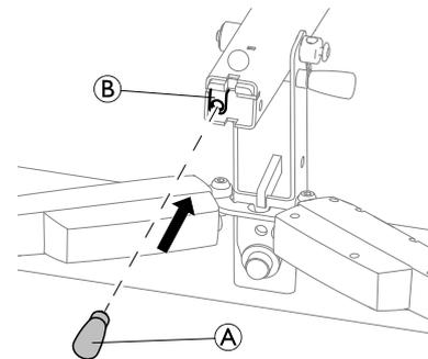
Führen Sie die Mastverlängerung ① in die Halterung ② an der Unterseite des eingeklappten Masts ein.
