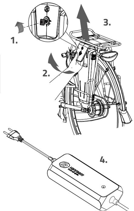
5. Stecken Sie **dann** den Ladeanschluss des Kabels in den Ladepunkt des Akkus. Die rote LED leuchtet auf. Das Ladegerät ist nun am Aufladen.
