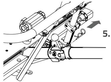
7. Ziehen Sie den Rollstuhlradeil aus der Kupplung. **Achtung!** Das Rollstuhlradeil ist schwer. Halten Sie den Rahmen mit beiden Händen gut fest.
