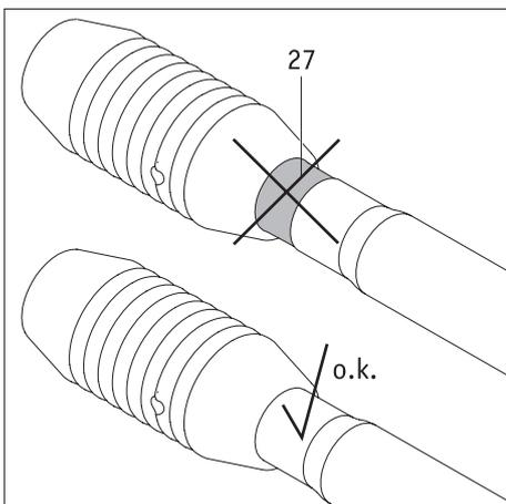
**!** Prüfen Sie in regelmäßigen Abständen die korrekte Position der Adapterachse [22] an den Steckachsen des Rollstuhls. Die Griffe [23] dürfen sich niemals über die Sperrkugeln [24] schieben lassen!
