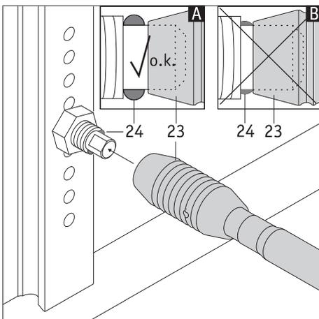
**!** Prüfen Sie nach Anbringen der Adapterachse [22] deren sicheren Halt. Ebenfalls darf die rote Markierung [27] nicht mehr sichtbar sein. Ist die rote Markierung [27] sichtbar, darf der smooV nicht mehr in Betrieb genommen werden. Wenden Sie sich an Ihren Fachhändler um die Adapterachse [22] neu auf Ihren Rollstuhl justieren zu lassen. Eventuell muss auch eine neue Adapterachse angeschafft werden.
