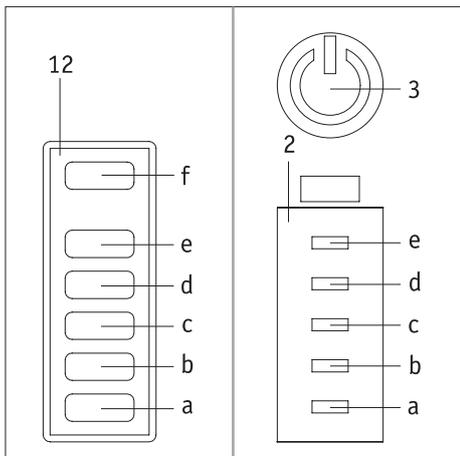
Während des Ladevorganges wird in den Anzeigen [2] (Antriebseinheit) und [12] (Bedieneinheit (nur wenn eingeschaltet)) der jeweils aktuelle Ladezustand des Akkus der Antriebseinheit wie folgt angezeigt:
