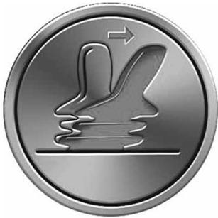
Wenn die Sondersteuerung vor oder gleich nach dem Einschalten des Steuersystems betätigt wird, erscheint die Anzeige Joystick nicht in Grundstellung.
