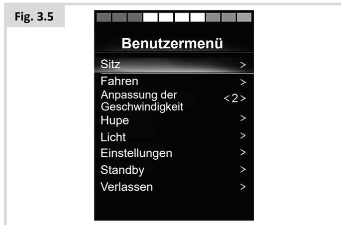
OMNI2 scannt nacheinander die einzelnen verfügbaren Verstellmotor'achsen', zum Abschluss erscheint die Option 'Verlassen' (Fig. 3.6), um zum Fahren, zum Benutzermenü oder zur nächsten Funktion in der Sequenz zurückzukehren.
