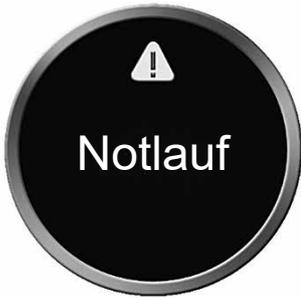
Diese Meldung wird angezeigt, wenn ein Eingabegerät nicht mehr angeschlossen ist und das OMNI2 so programmiert ist, dass die Fahrt nur noch langsam fortgesetzt werden kann.
