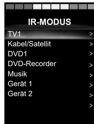
Jedem Gerät ist eine Liste von IR-Befehlen zugeordnet: Zum Beispiel bei TV werden Befehle wie: Ein/Aus, Kanal Höher, Kanal Niedriger, Lautstärke Höher und Lautstärke Niedriger angezeigt. Wenn OMNI2 den ausgewählten Befehl sendet, wird dieser rot markiert (Fig. 5.13).
