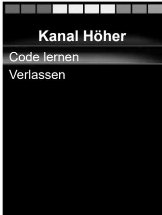
6. Halten Sie die TV-Fernbedienung auf die LED am Empfänger des OMNI2 gerichtet und drücken Sie die Taste Kanal Höher an der Fernbedienung zweimal (Fig. 5.18).
