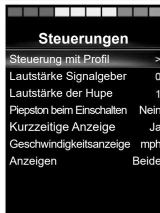
**Steuerungen mit Profil>Standby** – damit wird die Zeitdauer eingestellt, nach der die Steuerung auf Standby schaltet, wenn kein Befehl von der Sondersteuerung empfangen wird.
