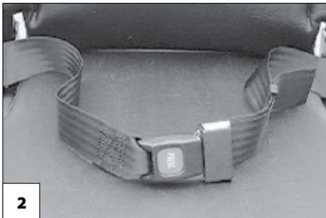
Der Haltegurt [2] wird von hinten an das jeweilige Rückenlehnenrohr angeschraubt (1). Der Haltegurt dient der Stabilisierung der Sitzposition und verhindert ein nach vorn aus dem Elektrorollstuhl kippen.
