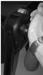
Schlagen Sie auf den Knauf, um den Feststellmechanismus zu lösen.
