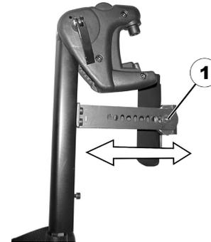
1. Mutter (1) mit dem Gabelschlüssel lösen und entfernen.
