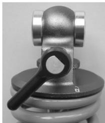
Die Suspension und die Stoßdämpfung sind gesperrt.
