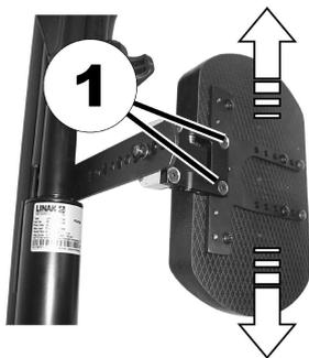
1. Schrauben (1) mit dem Innensechskantschlüssel lösen.
