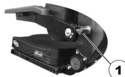
1. Lösen Sie den Drehknopf zur Verstellung des Armlehnen-Winkels (1).
