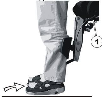
2. Füße auf die Fußplatten stellen und den Hebel (1) ziehen. Die Fußplatten senken sich sanft zum Boden ab.
