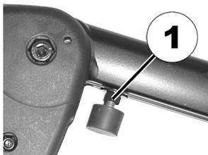
Kontermutter (1) mit dem Gabelschlüssel lösen.
