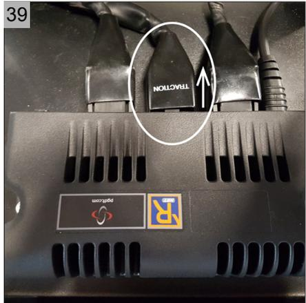
In manchen Fällen muss das Stromkabel der Steuerung getrennt werden (siehe Abb. 39):
