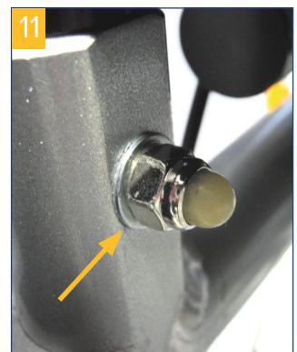
Zum Verstellen der Rückenlehne lösen Sie die Muttern links und rechts unten am Führungsrohr der Rückenlehne (**Bild 11**).
