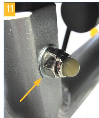
Per regolare la spalliera, svitare i dadi a destra e a sinistra sotto il tubo guida della spalliera (fig. 11).
