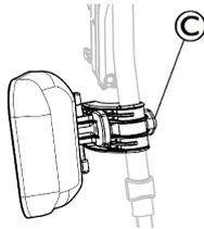
1. Lösen Sie die Knebelschraube ©.
