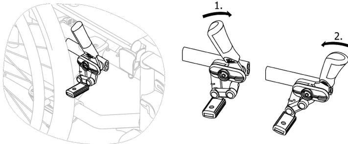
1. Zum Betätigen der Bremse drücken Sie den Bremshebel mit der Handfläche so weit wie möglich nach vorne.
