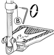
1. Lösen Sie die Fixierschraube **B** mit einem 5-mm-Inbusschlüssel.
