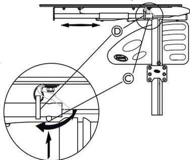
2. Drücken Sie auf den Federstift (C) und setzen Sie den Ring (D) auf das Rohr (A).
