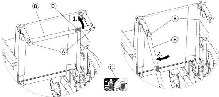
1. Lösen Sie die beiden Handschrauben **A** etwas, ziehen Sie die Rückenlehnenstrebe **B** nach oben, und drehen Sie sie dann entlang der Rückenlehne nach unten (links oder rechts).
