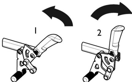
1. Zum Betätigen der Bremse ziehen Sie den Bremshebel mit den unteren Fingern so weit wie möglich nach hinten.
