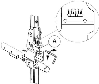
1. Die Einstellung des Rückenlehnenwinkels erfolgt mithilfe der Stellschraube (A).
