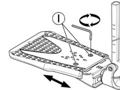
1. Lösen Sie die beiden Fixierschrauben **I** mit einem 5-mm-Inbusschlüssel.
