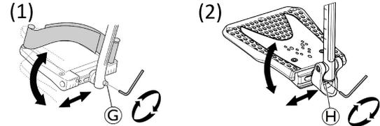
1. Lösen Sie die Fixierschraube **G** oder **H** mit einem 5-mm-Inbusschlüssel.
