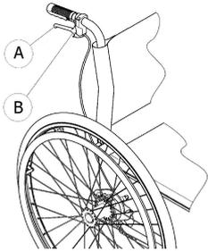
1. Ziehen Sie zum Bremsen den Bremshebel **A** am Schiebegriff.
