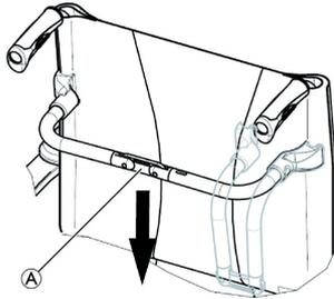
1. Entriegeln Sie die faltbare Rückenlehnenstrebe, indem Sie das Gelenk (A) leicht nach unten drücken.
