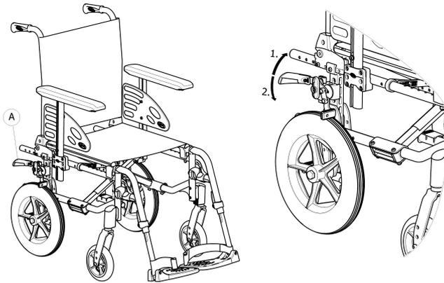
1. Zum Betätigen der Bremse ziehen Sie den Bremshebel so weit wie möglich nach oben.
