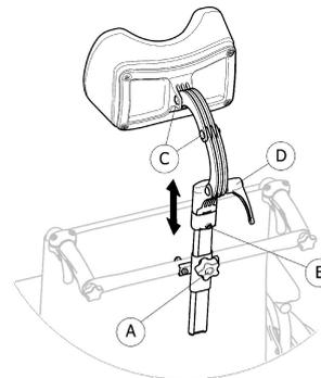
1. Lösen Sie die Schraube des Anschlags **B**.
