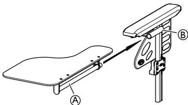
1. Führen Sie das Rohr des Halbtablets (A) in seine Aufnahme (B) unter der Armlehne ein.
