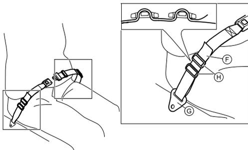
1. Führen Sie die Schlaufe **F** durch die Befestigung am Rollstuhl **C** und dann durch BEIDE Kunststoffschnallen **H**.
