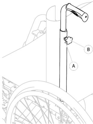
1. Um die Höhe der Schiebegriffe einzustellen, lösen Sie die Knebelschraube **A**, schieben den Griff auf die gewünschte Höhe, und ziehen die Knebelschraube wieder an.
