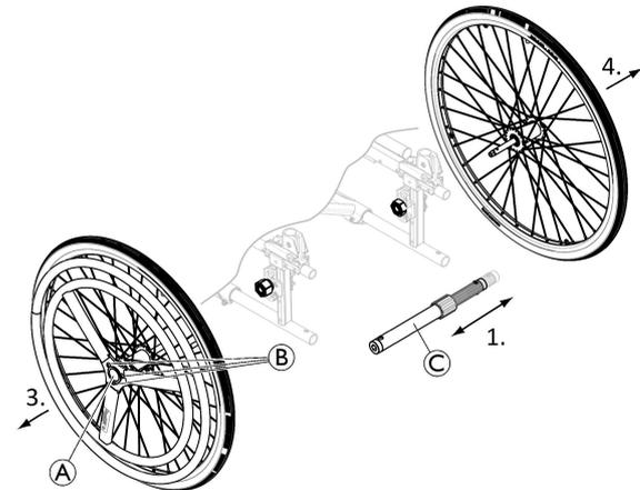
Die abnehmbaren und austauschbaren Hinterräder erleichtern den Transport sowie einen Wechsel der Steuerungsseite.
